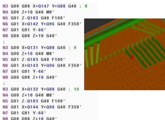
Rys. 2. Wybrane linie programu sterującego z wywołaniem zdefiniowanych parametrów geometrycznych obrabianych cech technologicznych w środowisku systemu Heidenhain iTNC640
