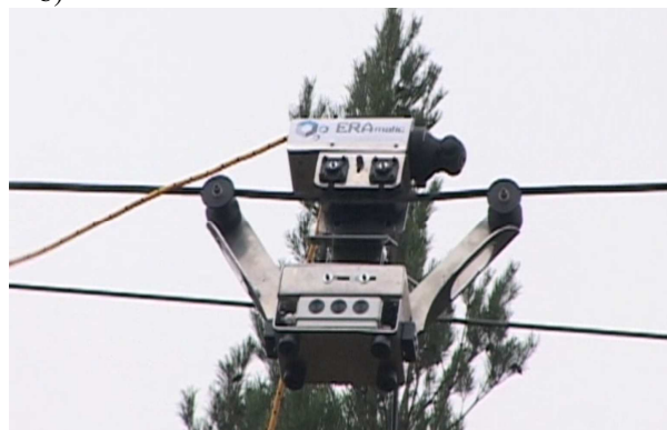
Rys. 2. Robot mobilny: a) model fizyczny robota – widok z przodu; b) rzeczywista maszyna zawieszona na przewodzie linii podczas prób weryfikacyjnych [1]
