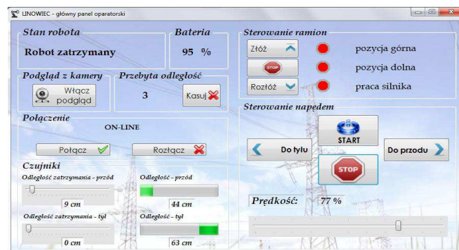
Rys. 4. Wygląd głównego okna aplikacji sterującej robotem mobilnym
