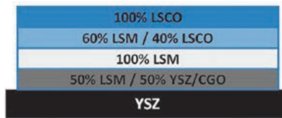
Rys. 1. Schemat półogniwa przedstawiający układ gradientowej katody na podłożu YSZ [25]
