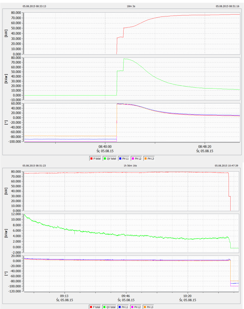
Rys. 17. Przebiegi mocy czynnej, biernej pierwszej harmonicznej i kąta między pierwszą harmoniczną napięcia i prądu
