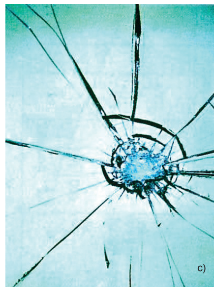
Rys. 7. Zmiana rozkładu naprężeń w szkłe pod wpływem wzrastającego obciążenia prostokądnego do powierzchni tafli
