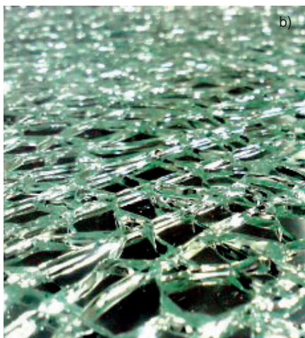
Rys. 8. Postacie rozbicia szkła płaskiego w zależności od stanu jego przerobu: a) float, b) hartowane, c) laminowane
