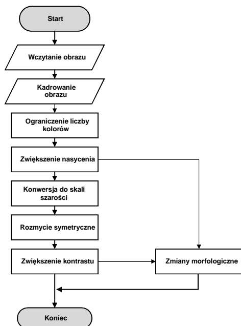
Rys. 3. Blok przygotowania obrazu do analizy - schemat przetwarzania obrazu
