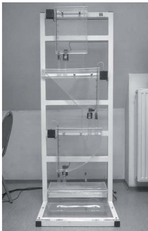
Rys. 1. Kaskadowy układ zbiorników Fig. 1. System of cascade tanks
