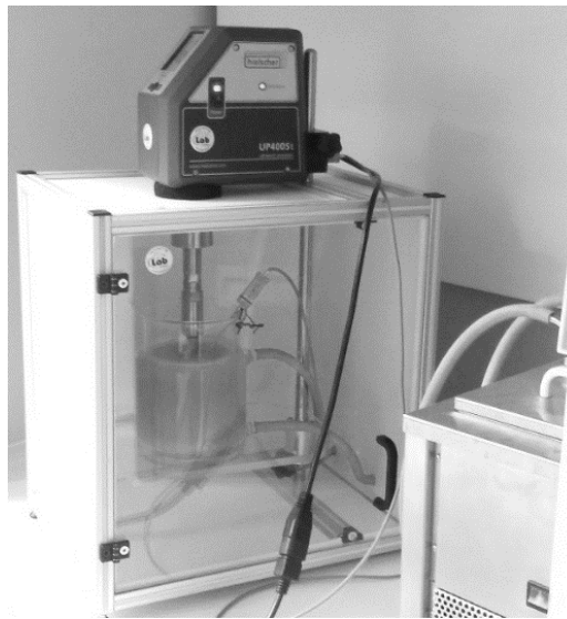
Fig. 6. Cavitation test stand
