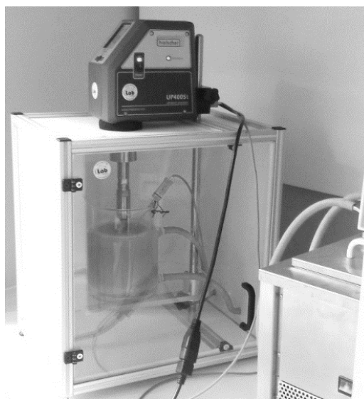
Fig. 6. Cavitation test stand
