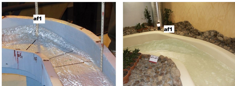
Ryc. 5. Przepływ wody w obiekcie „dzika rzeka” – model 1:10 i rzeczywistość Fig. 5. Water flow along the “wild river” slide – model 1:10 and reality
