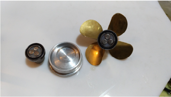
Rys. 15. Sprzęgło magnetyczne silnika głównego
