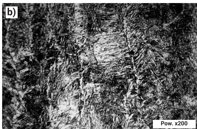
Rys. 4. Mikrostruktury badanych próbek: a) materiału rodzimego, b) spoiny. Trawienie Nital. Fig. 4. Microstructures: a) base material, b) weld. Etching Nital.
