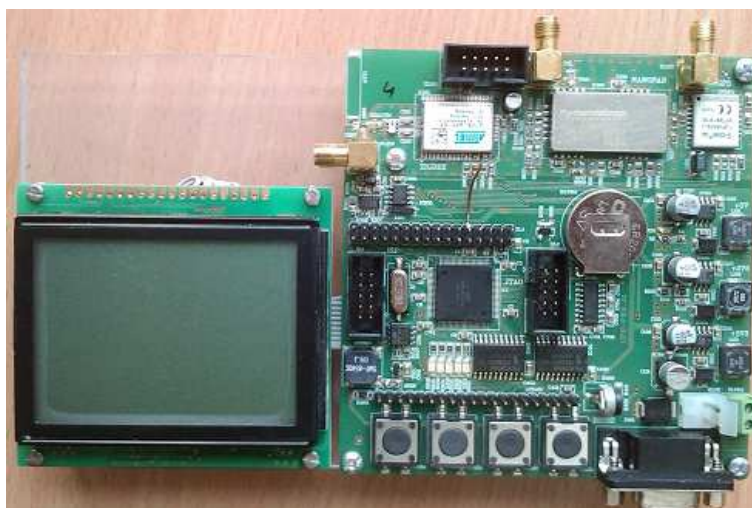
Rys. 4.5. Prototypowa wersja pośredniczącego węzła radiokomunikacyjnego PWR
