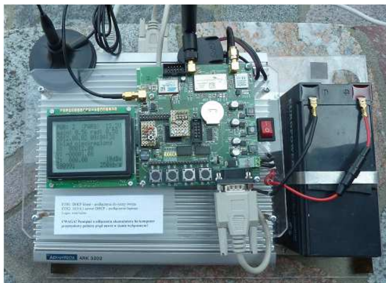
Rys. 4.6. Prototypowa wersja głównej stacji nadzoru GSN z podłączonym węzłem PWR
