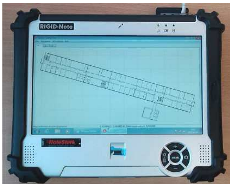
Rys. 4.7. Tablet przemysłowy jako komputer do wizualizacji położenia obiektów
