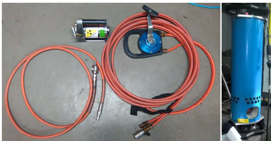
Rys. 5. Aparatura do RXRF: Izotop Se-75, lampa Rentgenowska.
