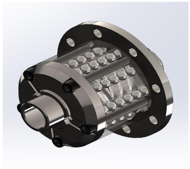
Rys. 8. Model 3D mechanizmu różnicowego wykonany w środowisku CAD
