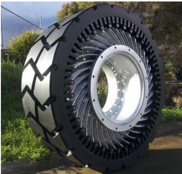
Rys. 15. Koło niepneumatyczne Go-Kart Wheel firmy Big Tyre (prototyp trzeciej generacji) z przeznaczeniem do stosowania w maszynach górniczych [11].
