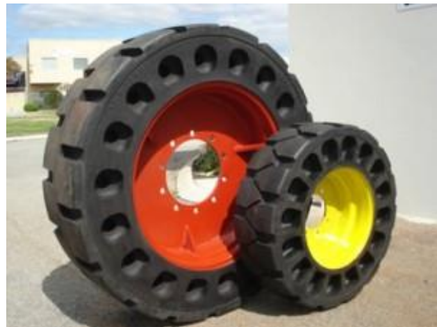
Rys. 17. Koła niepneumatyczne Crocodile firmy Croc Tires Pty Ltd [13] (mniejsze koło do wózków widłowych, większe do maszyn roboczych).
