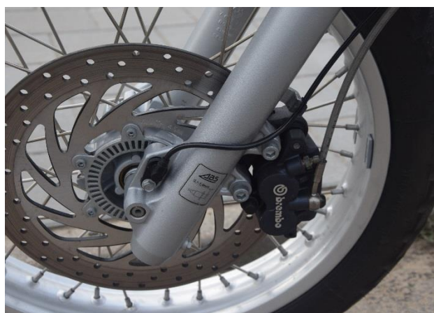
Rys. 3. Widok układu hamulcowego przedniego koła motocykla BMW F650 GS z układem ABS
