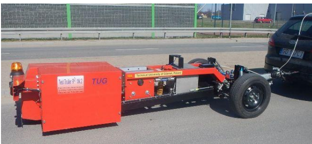
Rys. 1. Przyczepa R 2 Mk.2 do pomiaru współczynnika oporu toczenia opon i nawierzchni [5]
