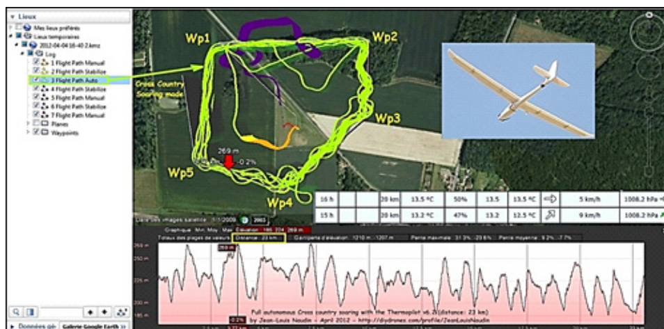
Rys. 6. Autonomiczny lot termiczny wykonany w oparciu o elektronikę COTS [31]
