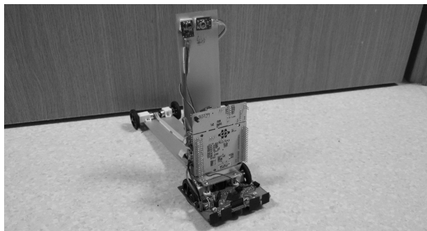
Rys. 6. Robot do automatycznego seryjnego pomiaru temperatury
