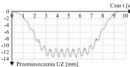
Rys. 8. Wynikowa funkcja przemieszczeń pionowych dolnego zamocowania krótkiej wanty dla przejazdu kolumny sześciu samochodów, z przeszkodą w środku przęsła Fig. 8. Final displacement function for vertical direction in short cable lower anchorage, under 6 trucks load, with threshold in the middle of span
