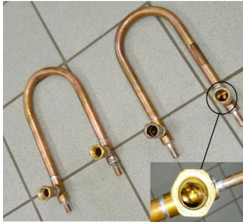
Rysunek 2. Widok na konstrukcje aparatów U-rurowych: od lewej konfiguracja z rurami gładkimi, od prawej konfiguracja z turbulizatorem helikoidalnym [opracowanie własne]
