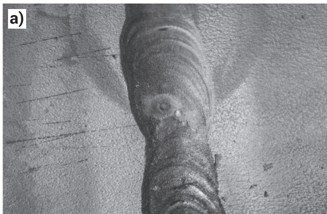
Rys. 5. Powierzchnia zewnętrzna kolana – perforacja ściany rury za spoiną (1) Fig. 5. Knee pipe outer surface – perforation of pipeline wall behind face of the weld (1)
