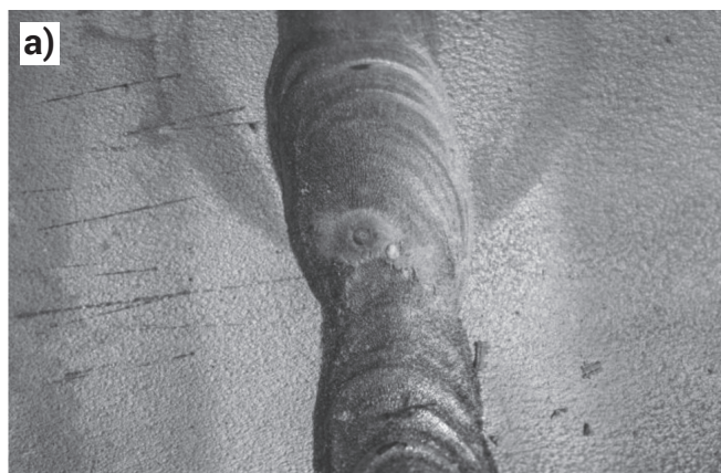
Rys. 5. Powierzchnia zewnętrzna kolana – perforacja ściany rury za spoiną (1)
