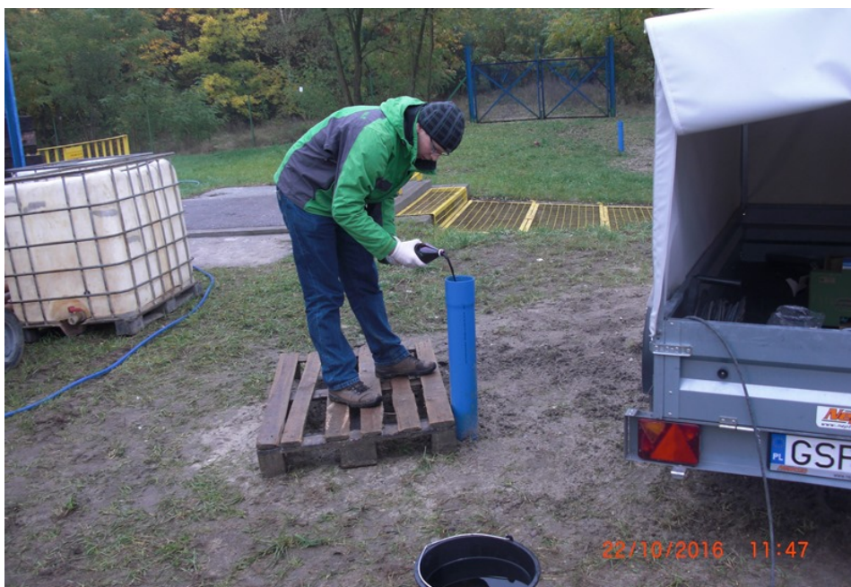
Rys. 6. Dawkowanie rodaminu WT do otworu badawczego.
