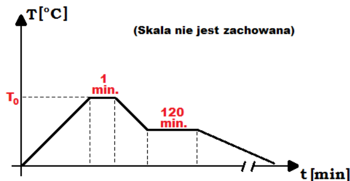
Rys. 2. Schemat grzania próbek materiału w piecu grzewczym.
