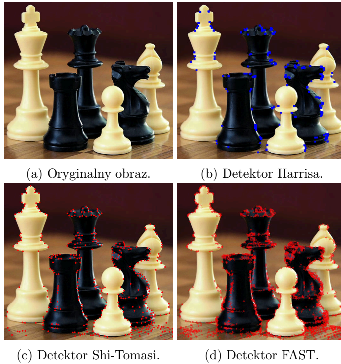
Rysunek 4.4 Wykrywanie narożników w obrazach na podstawie zdjęcia figur szachowych; prawa autorskie: A. Light, Wikimedia Commons, GFDL.
