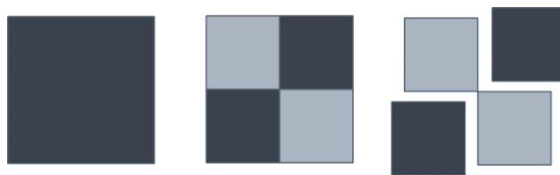
Rysunek 16. Schemat kwartowania odpadów komunalnych (wg PN-93-Z15006)
