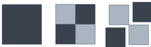
Rysunek 16. Schemat kwartowania odpadów komunalnych (wg PN-93-Z15006)
