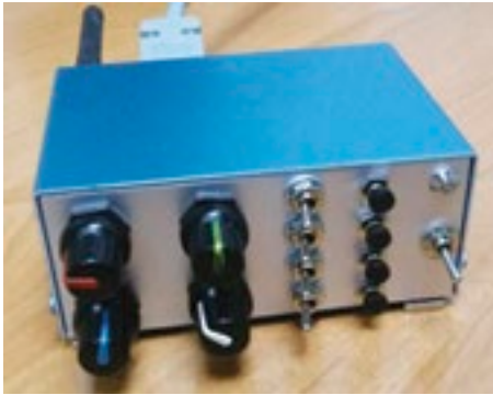
Fig. 4. A test module with the Fibaro RGBW controller Rys. 4. Moduł testowy z kontrolerem Fibaro RGBW
