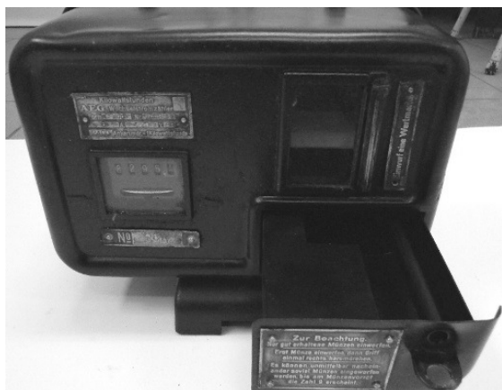
Rys. 5. Wygląd licznika GSLJc z otwartym pojemnikiem [6]
