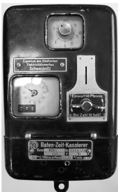
Rys. 1. Wygląd zewnętrzny licznika RZK1 [5]
