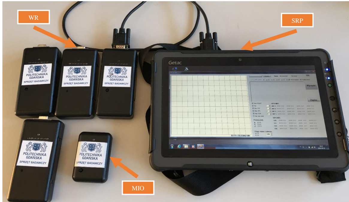
Rys. 5.1. Widok ogólny urządzeń prototypu hybrydowego systemu lokalizacyjnego
