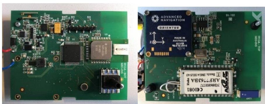
Rys. 5.4. Strona spodnia i wierzchnia obwodu PCB modułu identyfikacji osobistej MIO.
