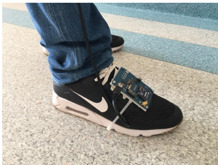
Rys. 4.1. Widok modułu inercyjnego umieszczonego na podbiciu stopy.
