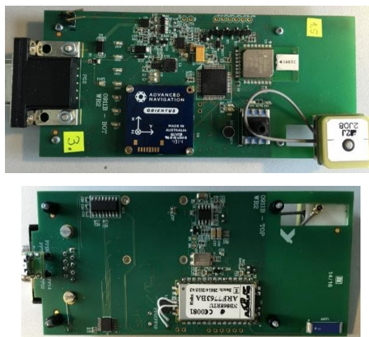
Rys. 5.6. Strona spodnia i wierzchnia obwodu PCB węzła referencyjnego WR.
