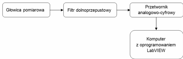
Rys. 2. Schemat blokowy systemu pomiarowego szumów elementów optoelektronicznych w zakresie małych częstotliwości
