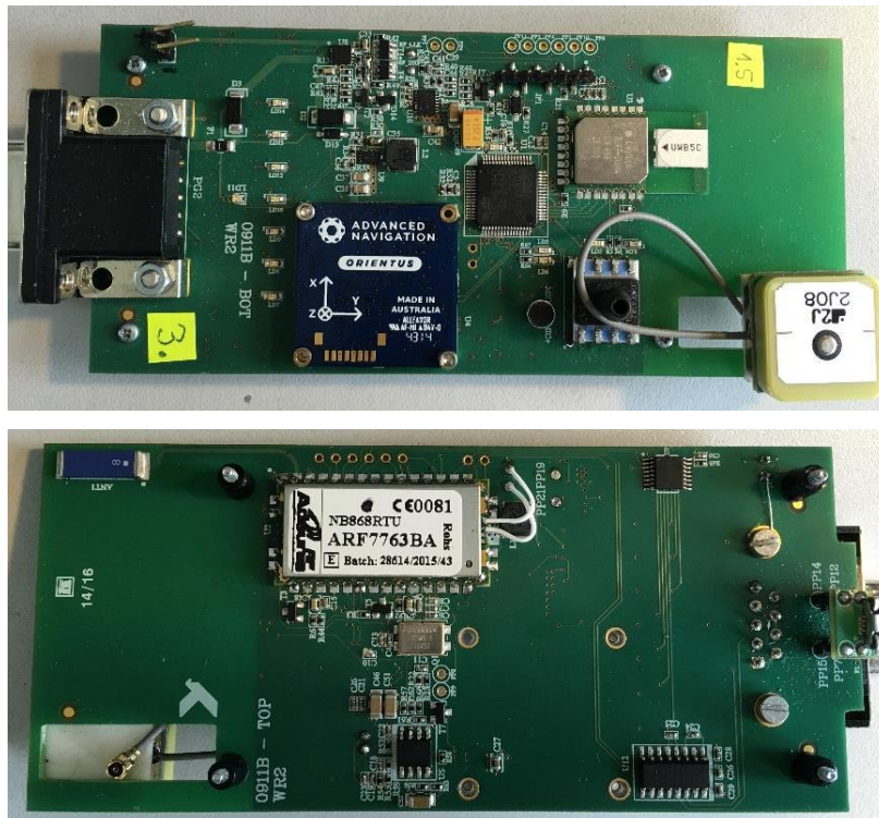
Rys. 4.8. Widok z góry (górne zdjęcie) oraz widok z dołu (dolne zdjęcie) obwodu drukowanego prototypu węzła referencyjnego.
