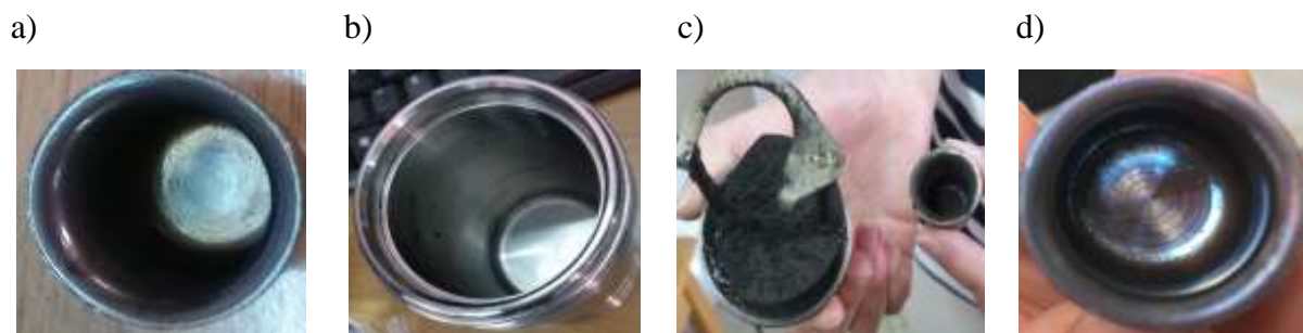
Rys. 3. Tygły bomb kalorymetrycznych z pozostałościami produktów spalania: a) Ekodiesel ULTRA (laboratorium Politechniki Gdańskiej), b) „ECA Fuel” RMD 80 (laboratorium Politechniki Gdańskiej), c) RMG 380 (laboratorium Politechniki Gdańskiej), d) RMG 380 (laboratorium Lotosu)
