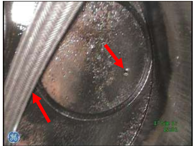
b) Dolna płyta głowicy, zawór wylotowy – widoczna sonda inspekcyjna wideoendoskopu, nieznaczne wgniecenie na powierzchni grzybka zaworowego
