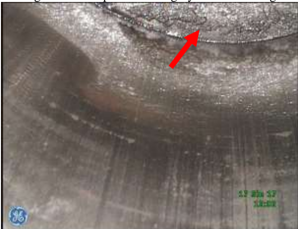
c) Przestrzeń robocza w rejonie GMP tłoka – osady nagaru na dolnej płycie głowicy
