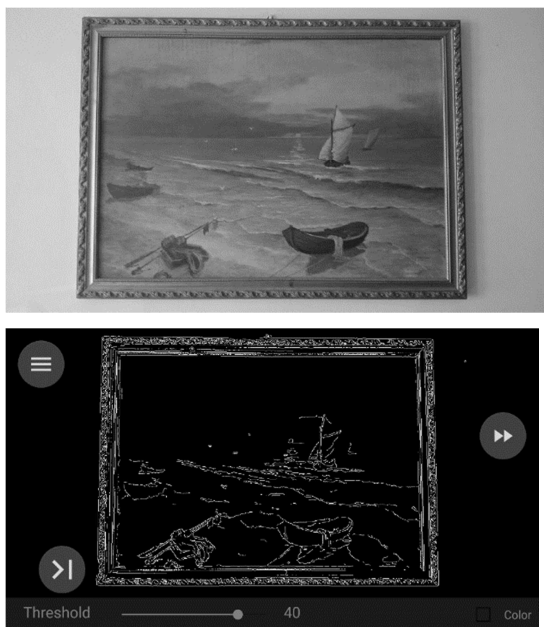
Rys. 5. Wykrycie krawędzi obrazu
