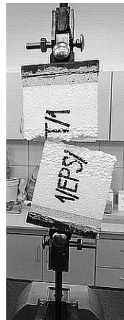
Rysunek 2.5. Mechanizm zniszczenia próbki EPS w badaniu jednoosiowego rozciągania
