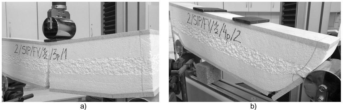
Rysunek 2.47. Mechanizm zniszczenia belek CSIP poddanych zginaniu przy rozstawie podpór L_0 = 600 mm; a) trójpunktowe zginanie; b) czteropunktowe zginanie
