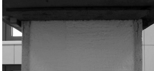
Rysunek 2.37. Mechanizm zniszczenia próbki CSIP o niezmienionej grubości w badaniu ściskania na sztorc
