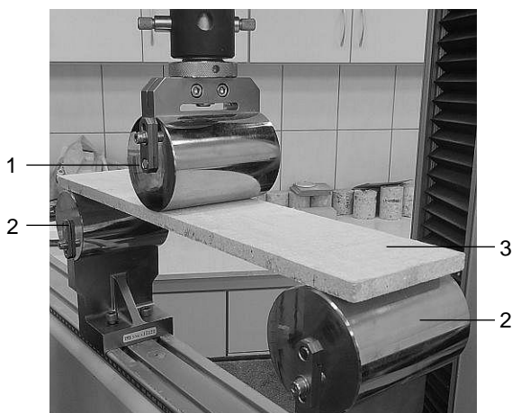
Rysunek 2.28. Stanowisko badawcze próby trójpunktowego zginania płyty MgO; 1) głowica obciążająca; 2) walec podporowy; 3) płyta MgO
