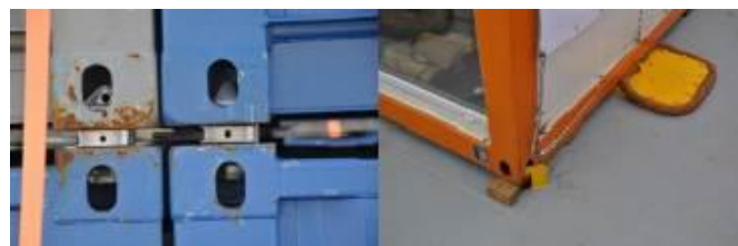
Rys. 6. Zabezpieczenia ładunku przed swobodnym przemieszczaniem [fot. Patrycja Jerzyło]
