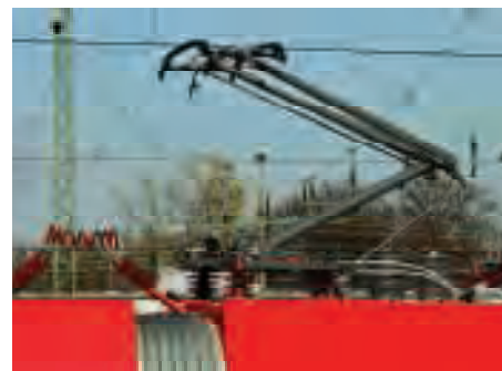
3. Odbierak prądu z sieci trakcyjnej (fot. Mario Schürholz www.bahnbilder.de )
