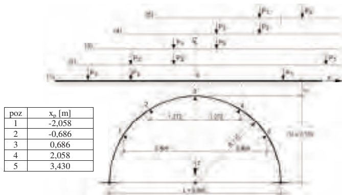
4. Położenia samochodu w realizacji koncepcji obciążenia kroczącego
