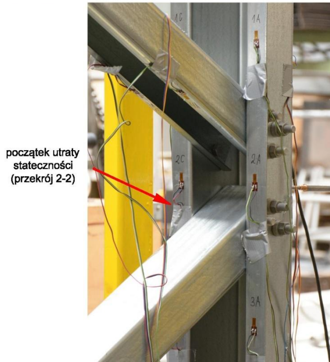
Rys. 5.20. Początek utraty stateczności przekroju kapeluszowego (na przykładzie modelu nr 4 dla wartości obciążenia P=5 kN, H_{\text{odp}}=95 kN).
