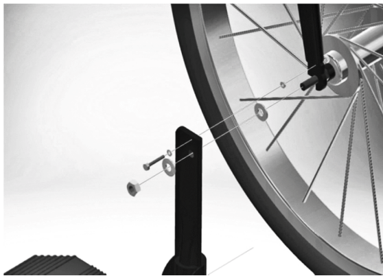
Rys. 5. Wizualizacja łączenia podnóżka z ramą konstrukcyjną Fig. 5. Visualization of connecting the footrest with the construction frame
