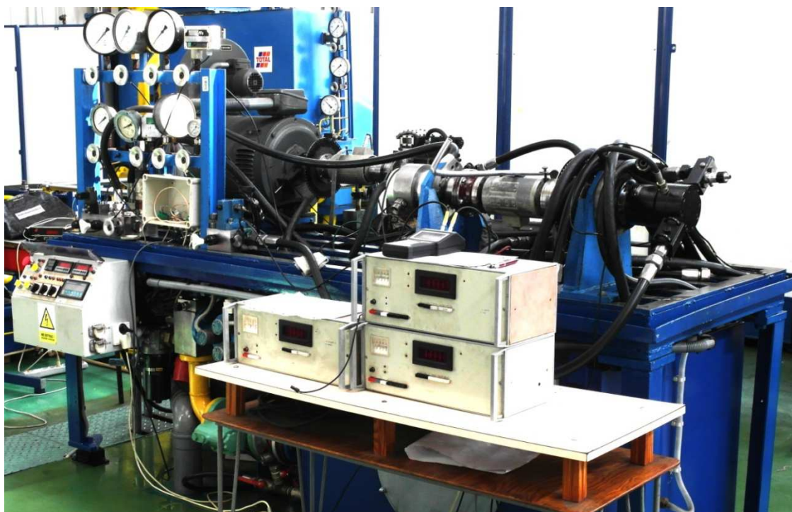
Rys. 9.16 Widok stanowiska badawczego do badania pomp hydraulicznych w laboratorium Hydrauliki i Pneumatyki PG
