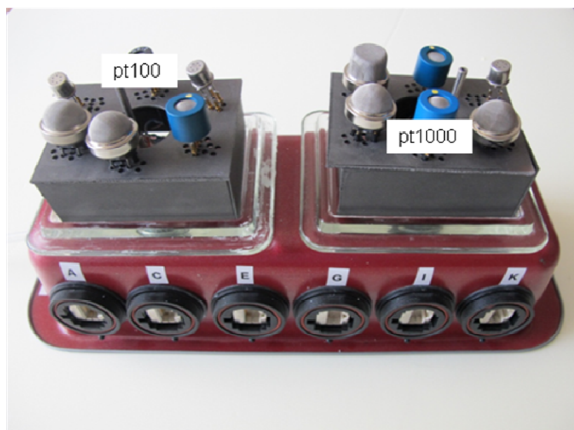
Rys. 38. Matryca czujników TGS firmy Figaro.
