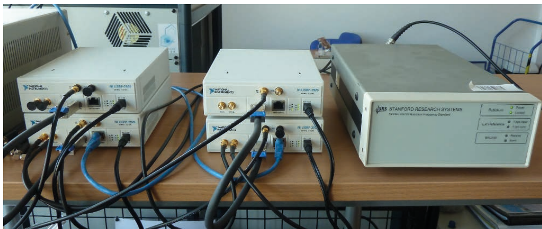
Rys. 4. Moduły radia programowalnego oraz rubidowy wzorzec częstotliwości
