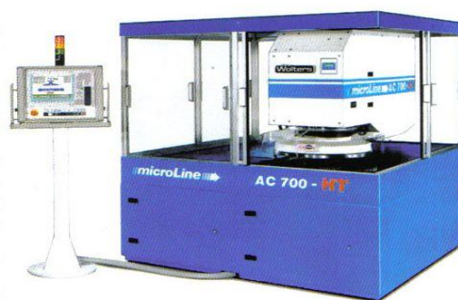
Rys. 5. Widok ogólny wysokowydajnego centrum szlifierskiego AC700-HT firmy Peter Wolters [5]
