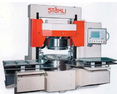
Rys. 2. Widok ogólny docierarki typu DLM firmy Stähli [6]
