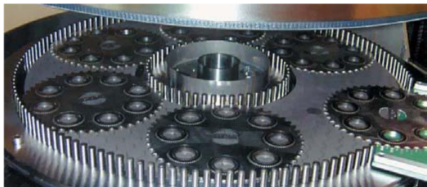
Rys. 3. Sposób wymiany separatorów w docierarce typu DLM firmy Stähli [6]
