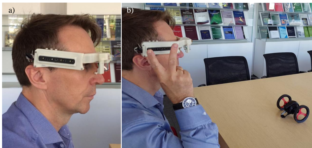
Rys. 5.4 a) Zastosowanie optycznego czujnika gestów o liniowej budowie w okularach eGlasses. Czarna część na tle białej oprawki to bloki optyczne czujnika gestów. b) Użytkownik okularów wykonujący gest 2FS wyzwalający jedną z akcji zachowania drona kołowego.
