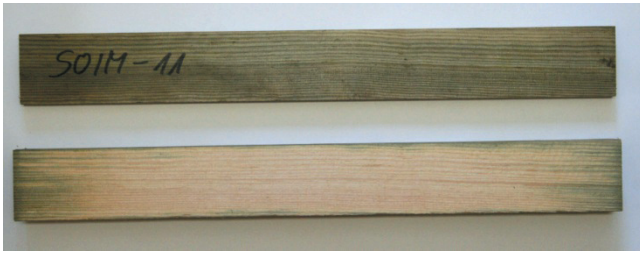
Rys. 1. Próbkę impregnowanego drewna sosnowego (nr próbki SOIM-11). Na górze pokazano powierzchnię zewnętrzną, a niżej – powierzchnię wewnętrzną po przecięciu
