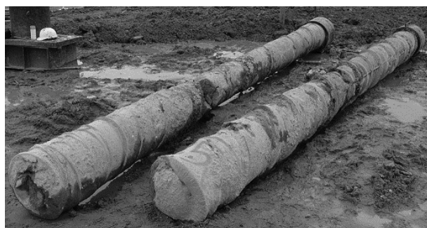
Rys. 1. Pale po wydobyciu z gruntu oraz wyodrębnione odcinki do badań betonu
