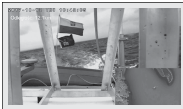
■ Rys. 8. Obraz przekazywany w czasie rzeczywistym z kamery umieszczonej na jednostce pływającej – z RTU przez łącze radiowe do RWSB w stacji stałej na lądzie (CTM): długość łącza 12,1 km, jednostka w ruchu, morze silnie pofalowane; w lewym dolnym rogu usytuowanie łącza radiowego pomiędzy RTU a CTM
