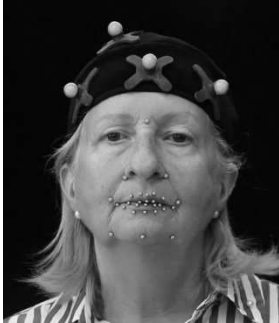
Rys. 1. Rozmieszczenie markerów na twarzy mówcy
