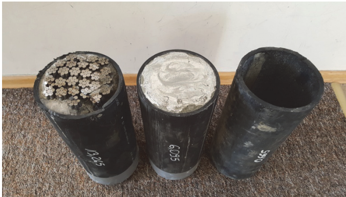
Rys. 4. Próbkę służące do określenia masy kabla, iniektu cementowego i osłony HDPE (fot. P. Kalitowski)
