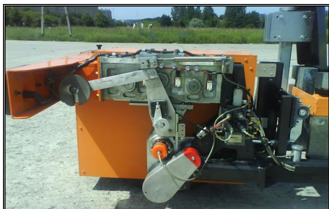
Rys. 15. Zawieszenie koła badanego i część toru pomiarowego w przyczepie R 2 Mk.1 wersji drugiej.
