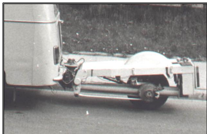
Rys. 1. Przyczepa pomiarowa do pomiarów przyczepności i oporu toczenia opon do samochodów osobowych, skonstruowana w Katedrze Pojazdów i Maszyn Roboczych Politechniki Gdańskiej [3].
